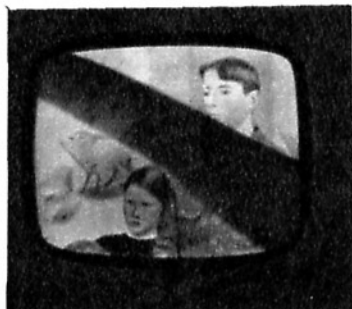
Снимок экрана при установленной выдержке 1/60 с, реально 1/75 с
